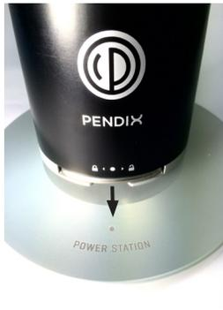
Bei Verwendung der Power Station müssen Sie lediglich darauf achten, dass der Punkt auf dem Akku zum Punkt auf der Power Station ausgerichtet ist. Durch Aufsetzen des Akkus zieht sich der magnetische Stecker an den Akku und wird elektrisch verbunden. Die Verbindung ist erfolgreich, wenn die LED-Anzeige aufleuchtet.
