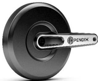
Der Pendix Antrieb ist ein effizienter, leistungsstarker Direktläufer, welcher ohne Getriebe und Freilauf arbeitet. Die Steuerung ist bereits in das smarte Design integriert. Der Pendix-Antrieb sitzt linksseitig am Fahrrad direkt am mitgelieferten Messtretlager, welches Ihre eingebrachte Trittkraft ermittelt. Der Motor unterstützt Sie entsprechend der eingestellten Unterstützungsstufe.
