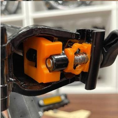
Stecken Sie die Krallen des Tubeslides auf die Gewindeaufnahme vom Haupttrahmenverschluss.
