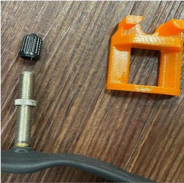
Lösen Sie die Ventilkappe und die Felgenmutter.
